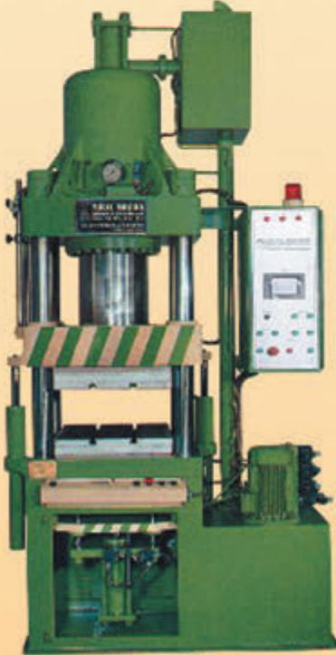
HLP 250/20 Ton İtçili otomatik gaz atmalı hidrolik lastik presi
