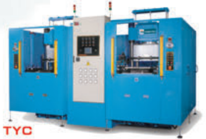
THP Yağ keçeleri v.b. kauçuk parçalar için vakumlu kopresyon presi
