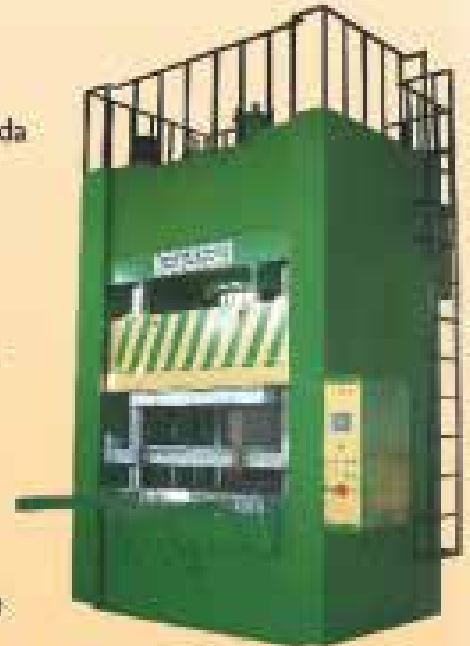
HLP 1000 Ton Kalıp sürücülü hidrolik lastik presi
