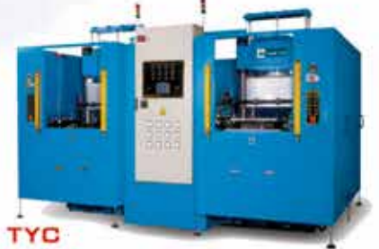
TYC O-ring, titreşim takozu, toz lastikleri v.b. kauçuk parçalar için vakumlu kompresyon presisi
