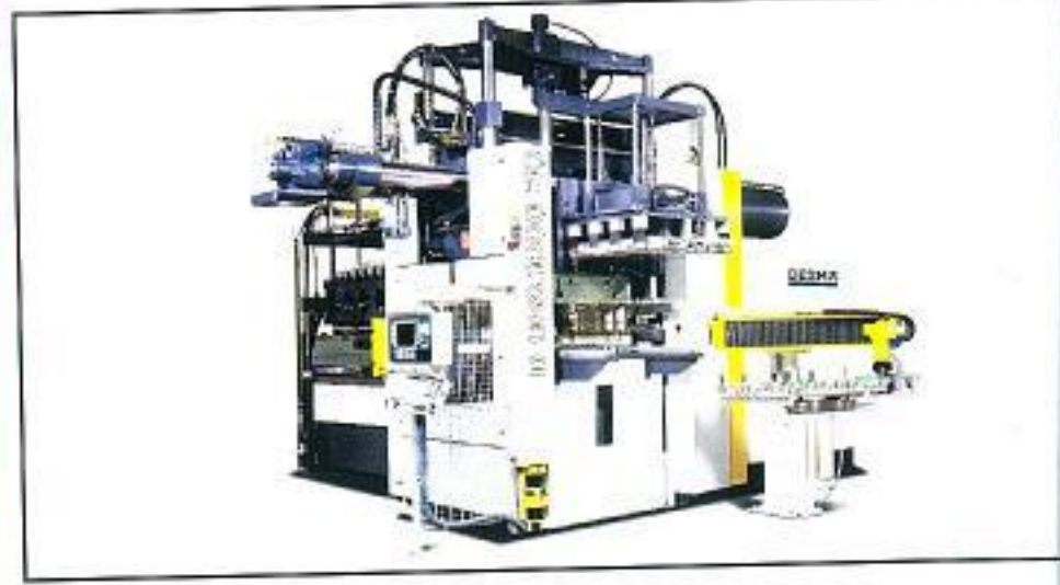
Şek.7: Kauçuk karışımı parçaların büyük miktarlarda üretimi için teçhizat
