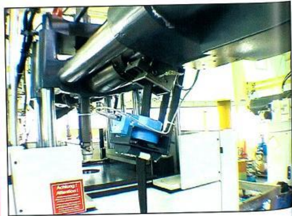
Şekil 1: Bir FIFO enjeksiyon ünitesinde bant izleme ve metal detektör içeren bir bant girişi
