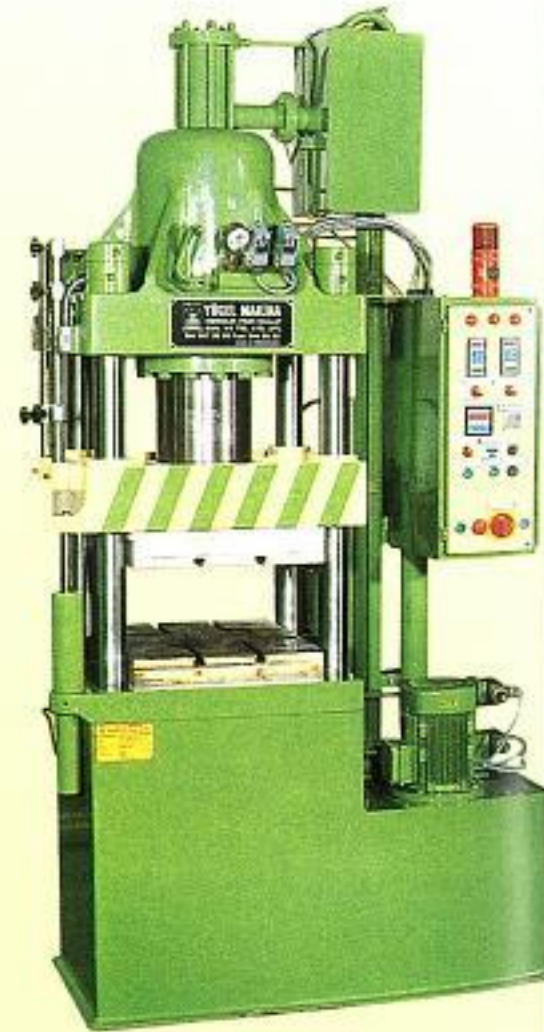
HLP 110 Ton Otomatik gaz atmalı hidrolik lastik presi
