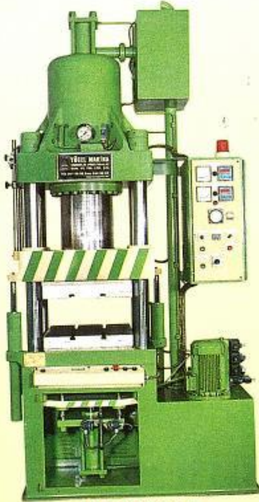
HLP 250/20 Ton İtici otomatik gaz atmalı hidrolik lastik presi
