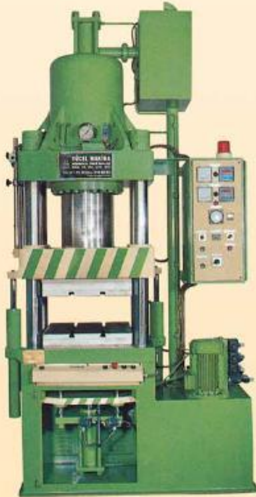
HLP 250/20 Ton Kıçılı otomatik gaz atmali hidrolik lastik presi
