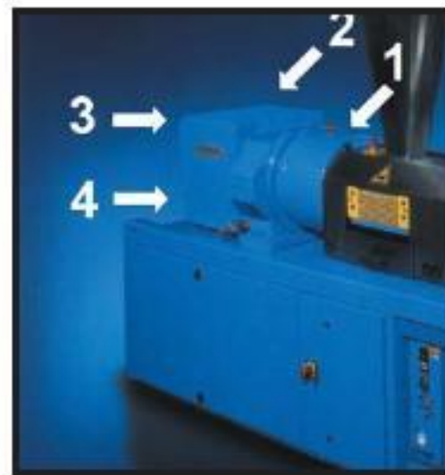
Yeni sistem dört motorlu ekstruder milini çevirme ünitesi.
