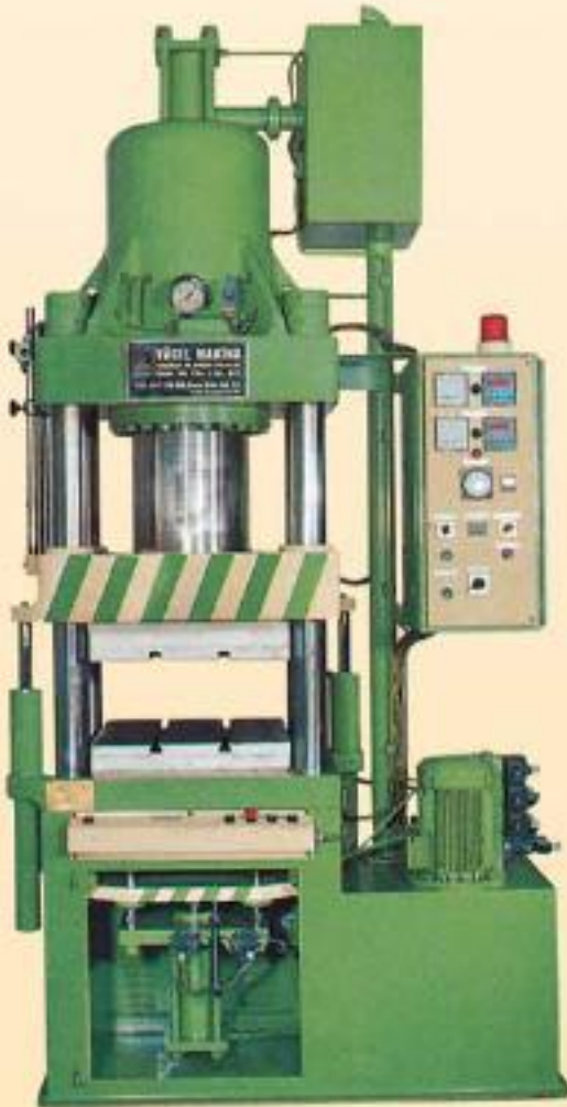
HLP 250/20 Ton Kıvılcı otomatik gaz atmalı hidrolik lastik presi
