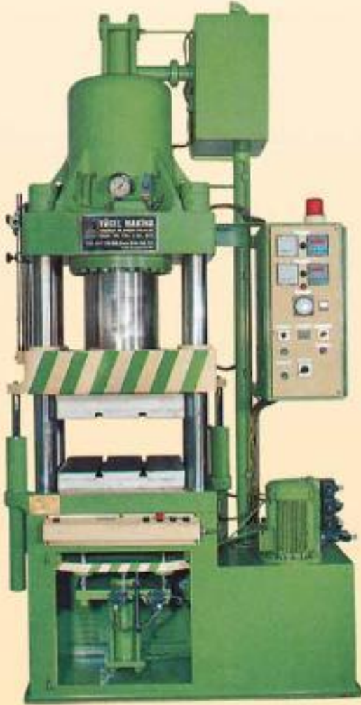
HLP 250/20 Ton Kıçılı otomatik gaz atmalı hidrolik lastik presi
