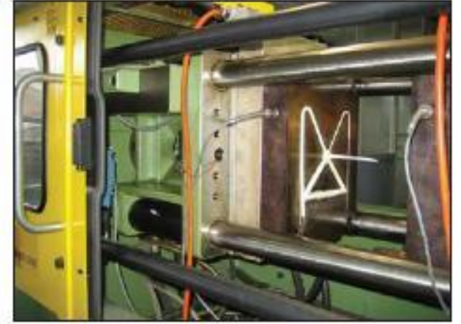
Resim 6: Struktol MC-I ile kalıp temizleme
