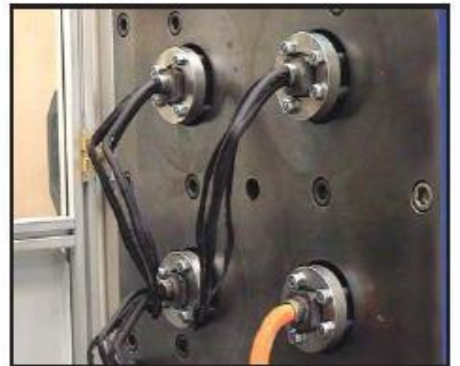
Karışım değişimi. FLOWCONTROL Soğuk Yolluk Bloku vulkanize karışımın atılımını mümkün kılar
