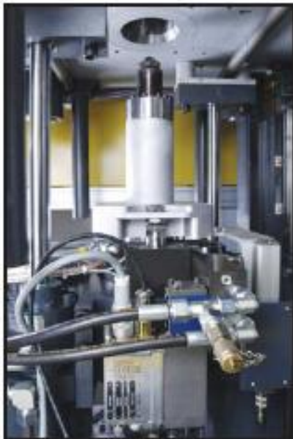
FLOWCONTROL+ nozzle, 3500 bara kadar hassasiyet ve basınç dayanıklılığı
