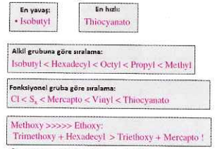
Şekil 6 : Silika-Silan bağlanma tepkimelerinin kinetiği [5]
