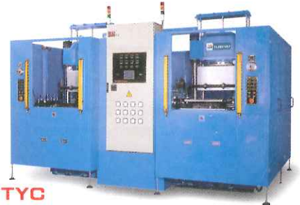
AUTO-TRIM Otomatik beslemeli çapak alma makinesi
