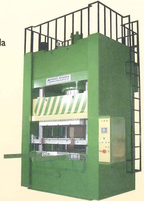
HLP 1000 Ton Kalıp sürücülü hidrolik lastik presi
