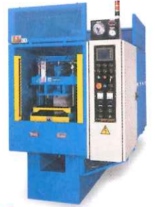
THP Yağ keçeleri v.b. kauçuk parçalar için vakumlu kompresyon presisi
