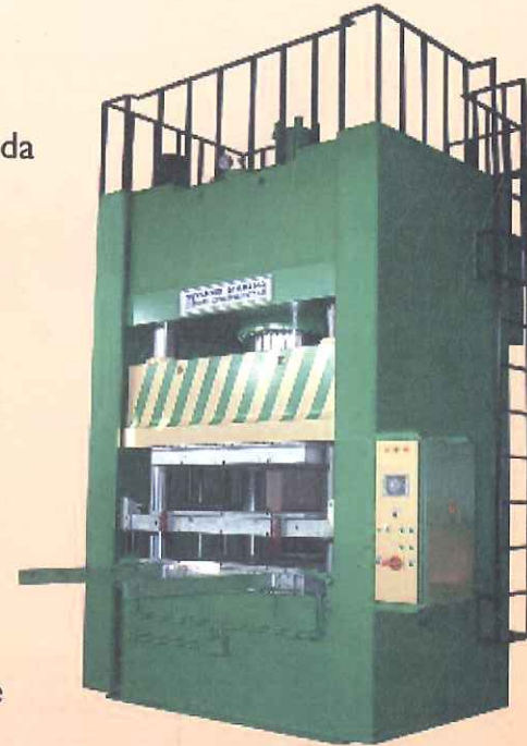
HLP 1000 Ton Kalıp sürücülü hidrolik lastik presi
